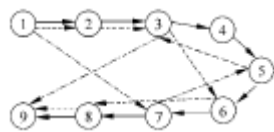
图 6.9 U 形生产线布局图
