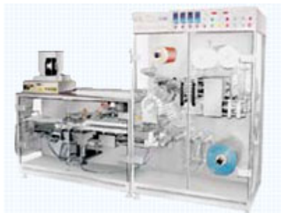
图 4-42 铝塑（铝-铝）泡罩包装机
