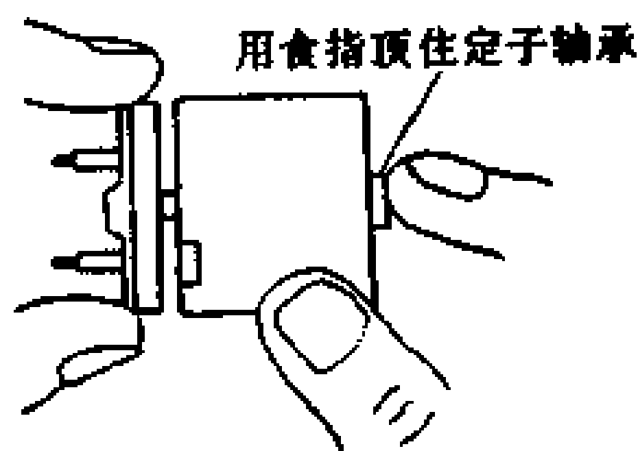
图 11-11 装配定子示意图
