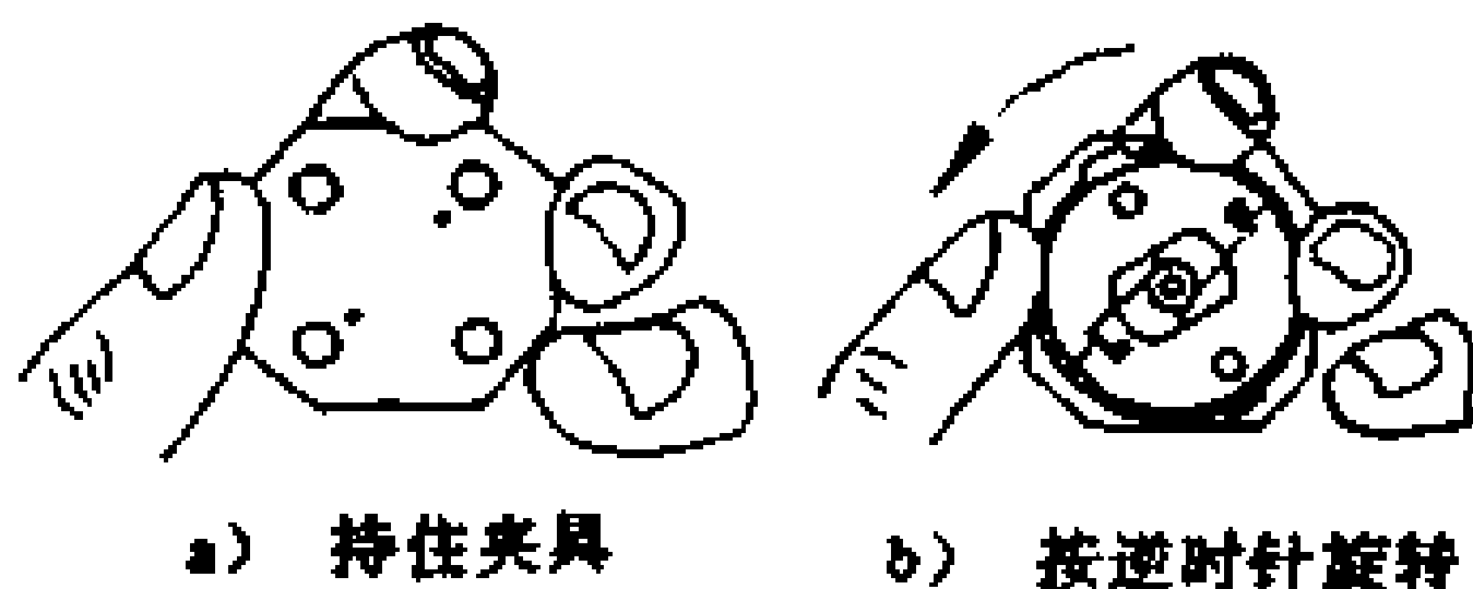
图 11-8 电刷压簧打开操作示意图
