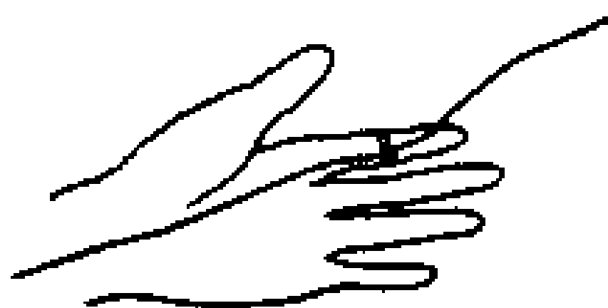
图 11-16 焊丝固定方法示意图
