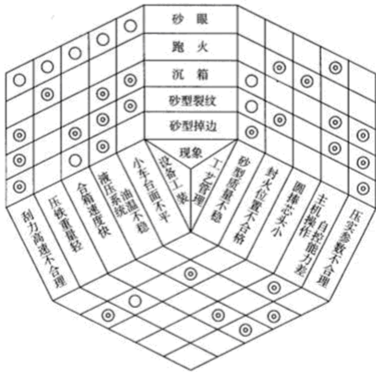
图 10-15 铸件质量与设备、工艺管理要因分析矩阵图(Y 型)
