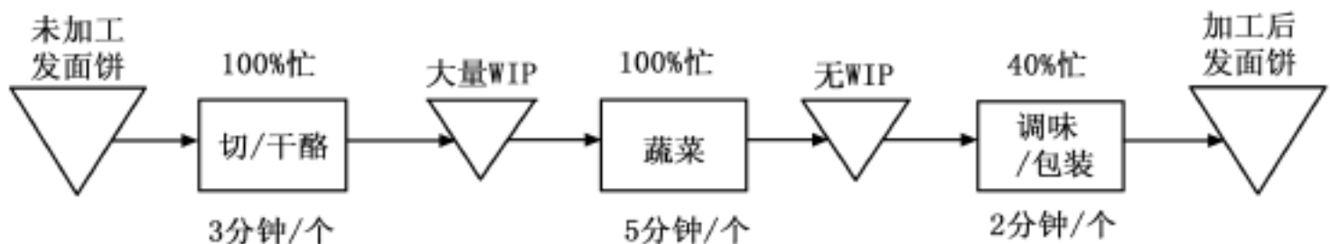
图 3 - 6 汉堡包生产流程
