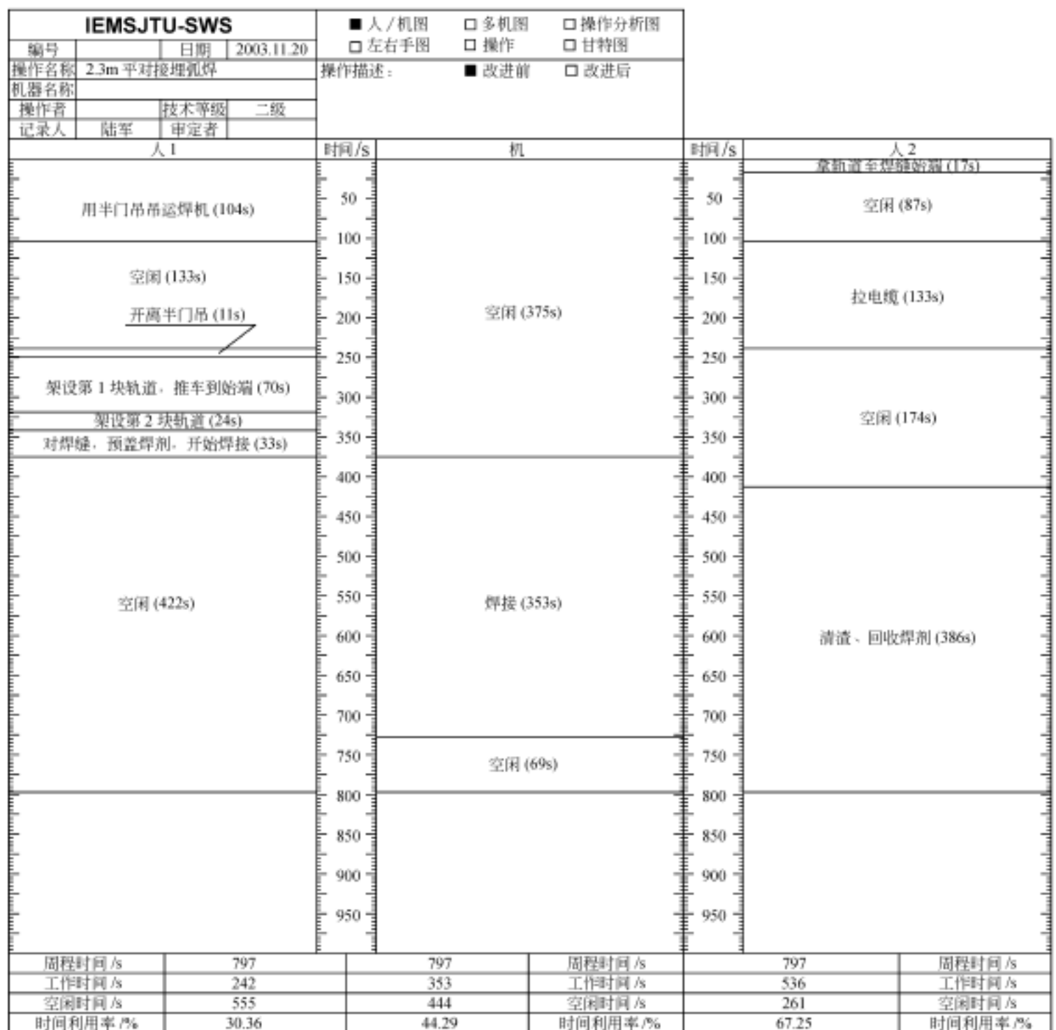
图 10.1 2.3m 平对接缝埋弧焊作业实测人机图
