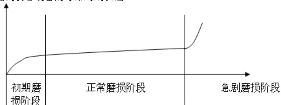
图 9-2 设备磨损曲线图
